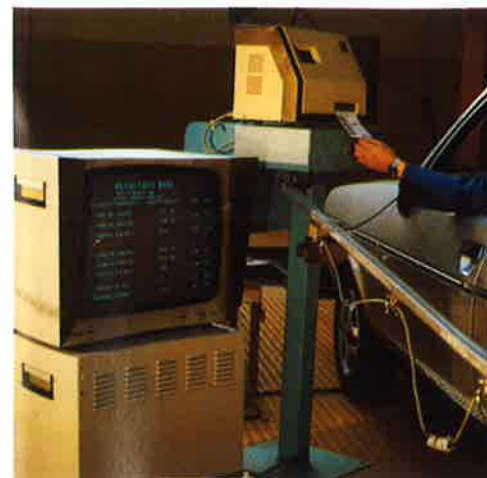
Contrôle électrique programmé
