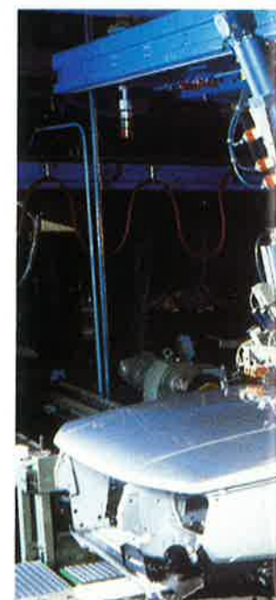
Opération de pose par robot d'un pare-brise sur une Renault 25
