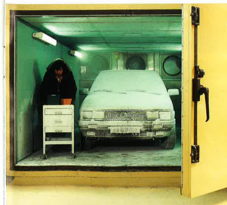
Contrôle de la montée en température du chauffage en chambre climatique.
