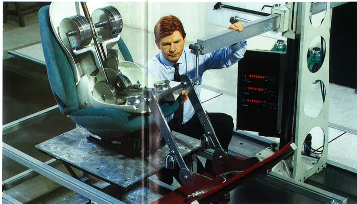
Recherche du positionnement optimal du conducteur sur son siège à l'aide d'un modèle biomécanique.
