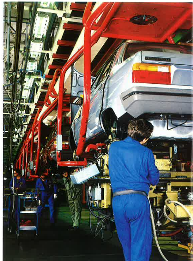
Nouveau système de convoyeur aérien à balancelles
