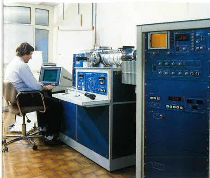
Spectromètre de masse couplé à un chromatographe en phase gazeuse, instrument d'analyse unique dans l'industrie automobile française.
