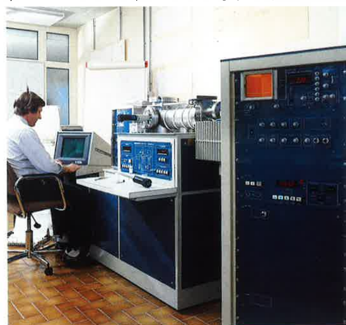
Spectromètre de masse couplé à un chromatographe en phase gazeuse.
