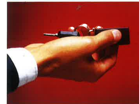
Commande à distances, à infrarouge de la condamnation électromotorisée des portes.
