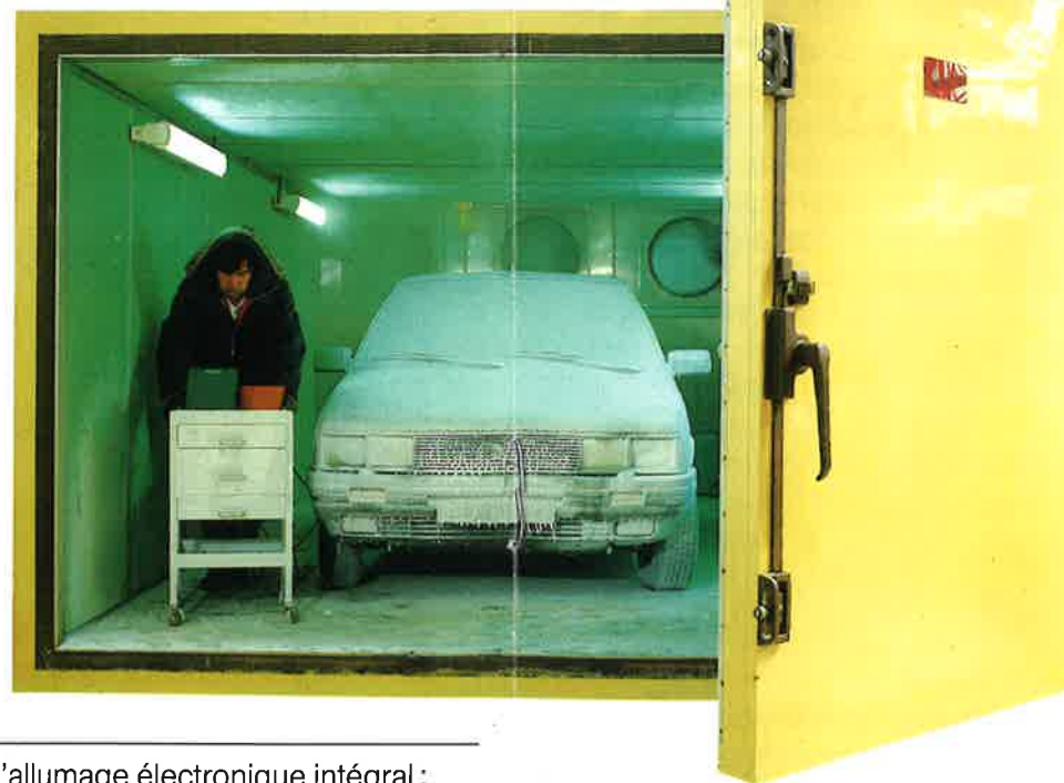
Contrôle de la montée en température du chauffage en chambre climatique.
